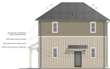
D ELEVATION A243-G 1/8" = 1'-0"
