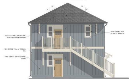
A ELEVATION A242-F 1/8" = 1'-0"
